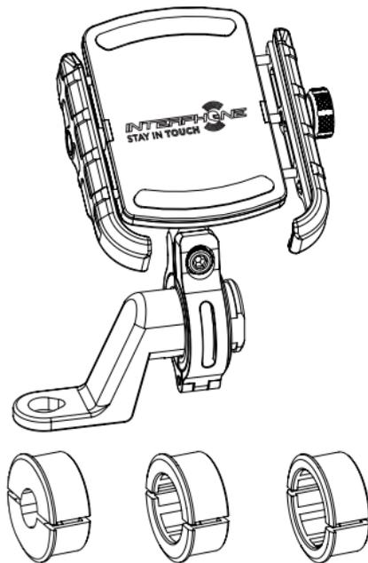
Diametri compatibili: da 12 a 32 mm, se necessario utilizzare i distanziali plastici in dotazione.
